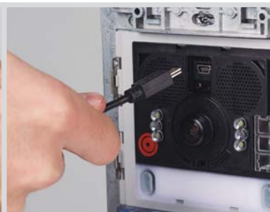
4 Realizar las regulaciones necesarias y configurar con PC
